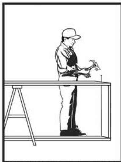
ASSEMBLARE IL CONTROTELAIO CON DEI CHIODI.
