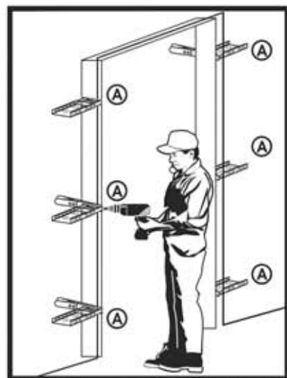
FISSARE PUNTI A CON VITI 3,9x9,5.
